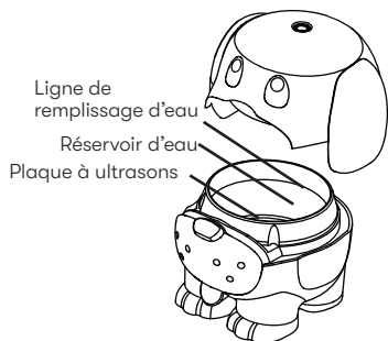
Vue de la base du diffuseur
